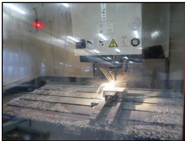
Obr. č. 20, MCV 100 Sprint, ukázka výroby elektrody
