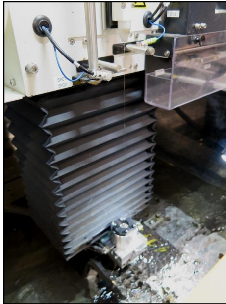
Obr. č. 9, FANUC ROBOCUT α600 IA [8], ukázka protažení drátu drátovou řezačkou
