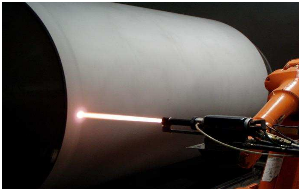
Obrázek 7 - Aplikace žárového nástřiku na povrch válce [11]
