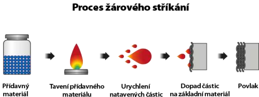
Obrázek 8 - Princip vytváření žárových nástřiků [14]
