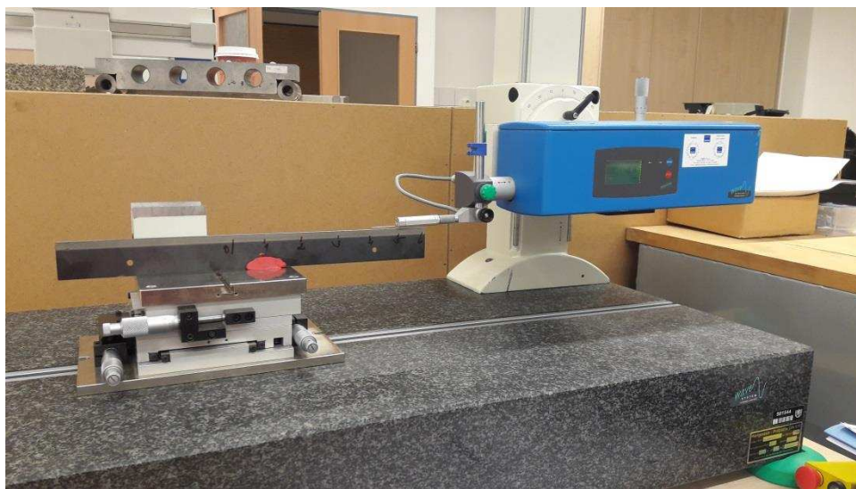
Obrázek 37 - Průběh měření drsnosti na Hommel Etamic T8000
