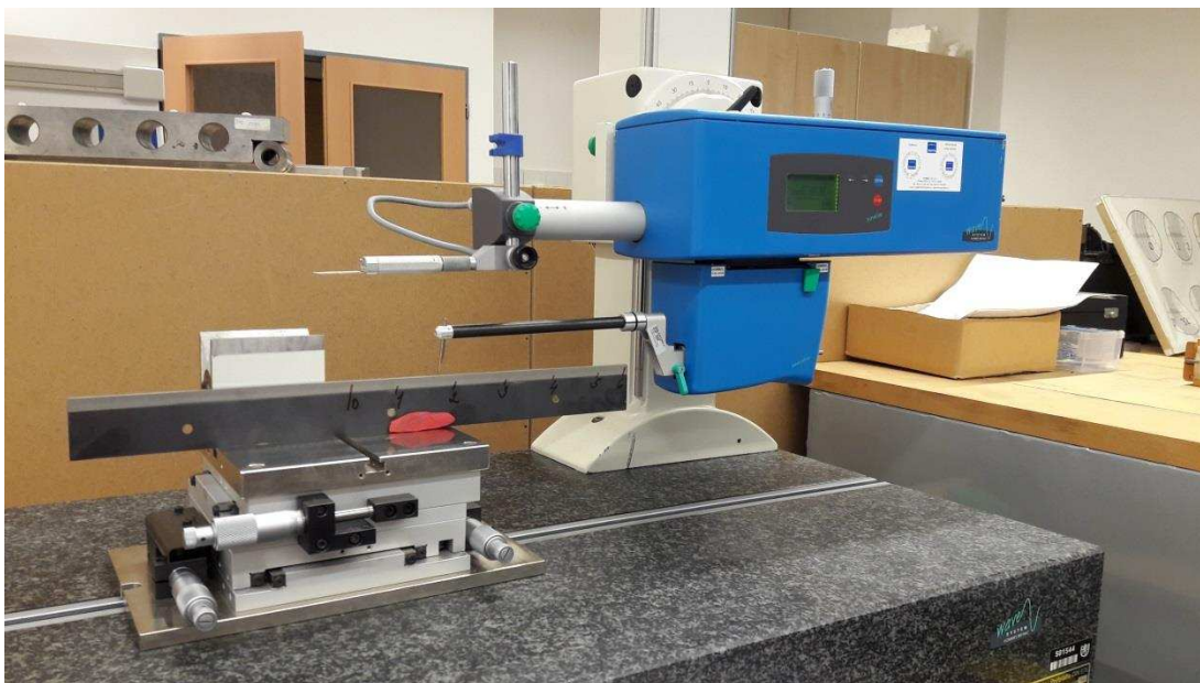
Obrázek 40 - Průběh měření profilu na Hommel Etamic T8000
