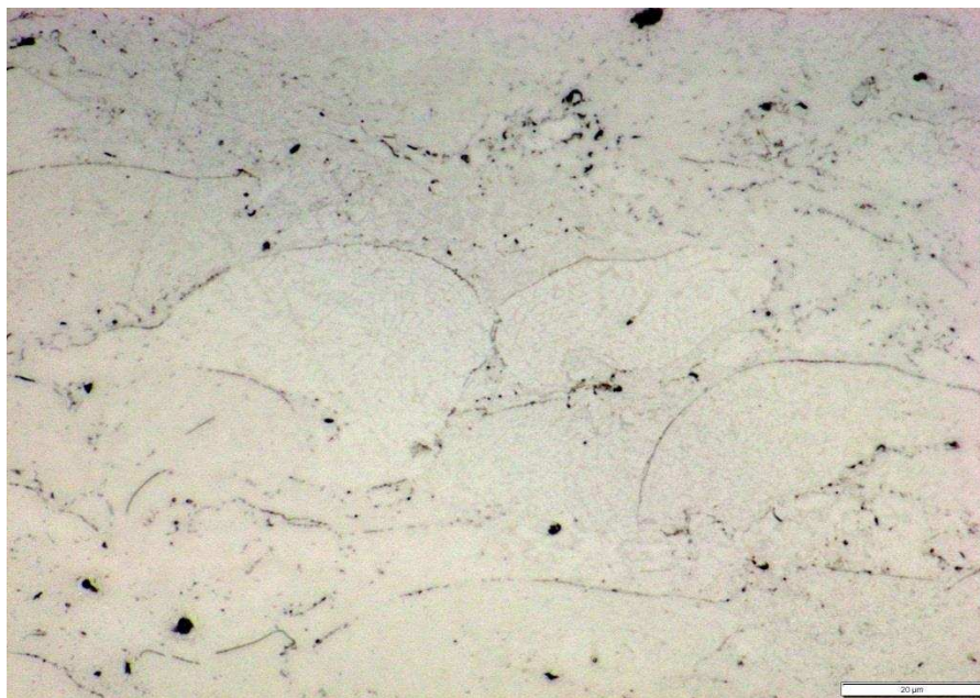
Obrázek 35 - Světelná mikroskopie (Olympus BX61, leptáno, zvětšení 1000x)
