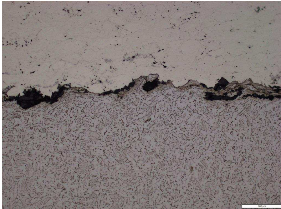
Obrázek 34 - Světelná mikroskopie (Olympus BX61, leptáno, zvětšení 200x)
