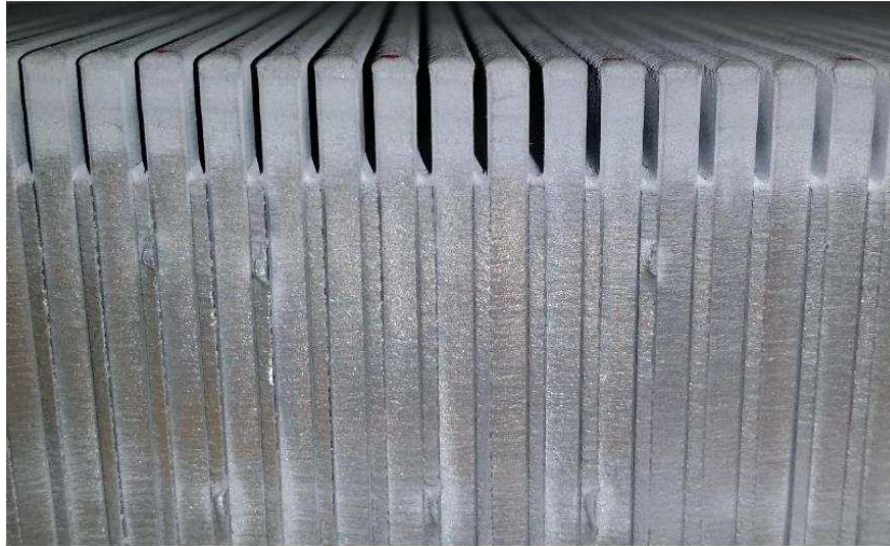
Obrázek 29 - Polotovary s již nanesenou stelitovou vrstvou [6]
