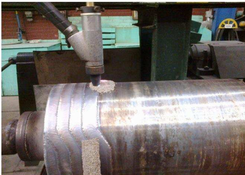
Obrázek 1 - Proces nanášení žárového nástřiku Stellite 6 [4]
