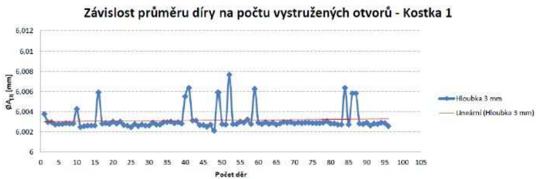
Obrázek 10. Závislost průměru na počtu vystružených děr – zkušební vzorek č. 1 [8]
