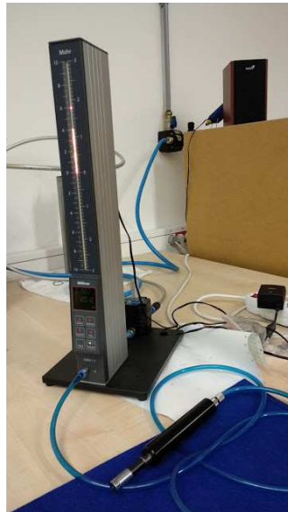
Obrázek 29. Vzduchový měřící přístroj Millimar S1840
