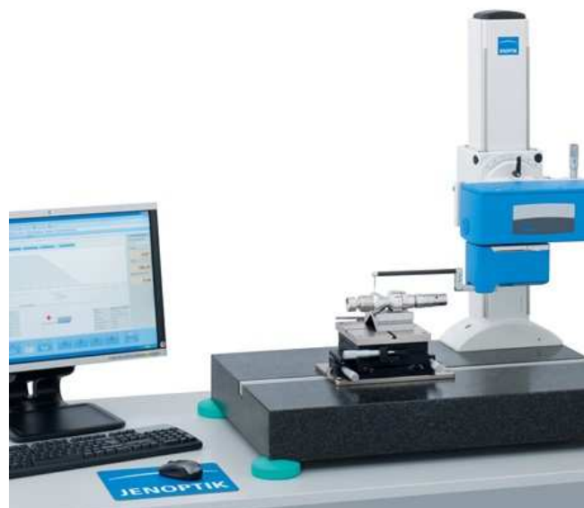
Obrázek 28. Drsnoměr Hommel Etamic T8000 [20]
