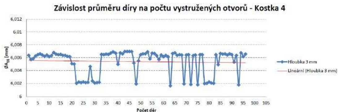
Obrázek 11. Závislost průměru na počtu vystružených děr – zkušební vzorek č. 4 [8]
