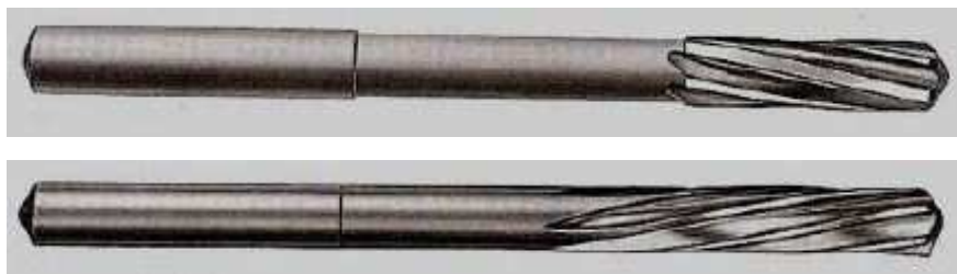
Obrázek 6. a) výstružník s přímými zuby, b) se zuby ve šroubovici – levá, pravá [4]
