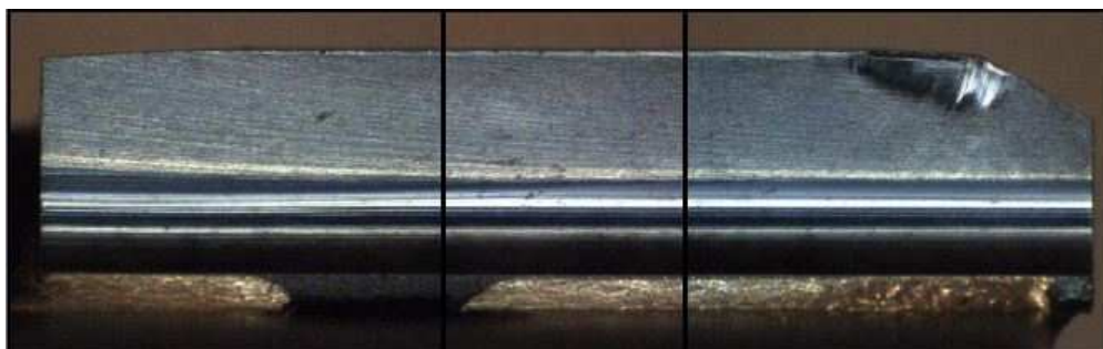
Obrázek 8. Opotřebení na čele nástroje [8]
