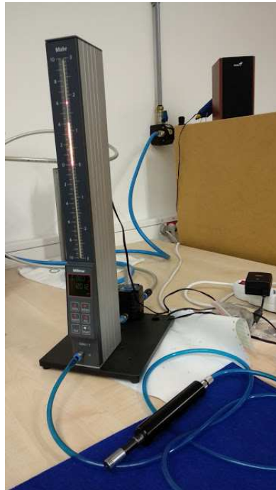
Obrázek P.3 - Vzduchový měřicí přístroj Millimar S1840
