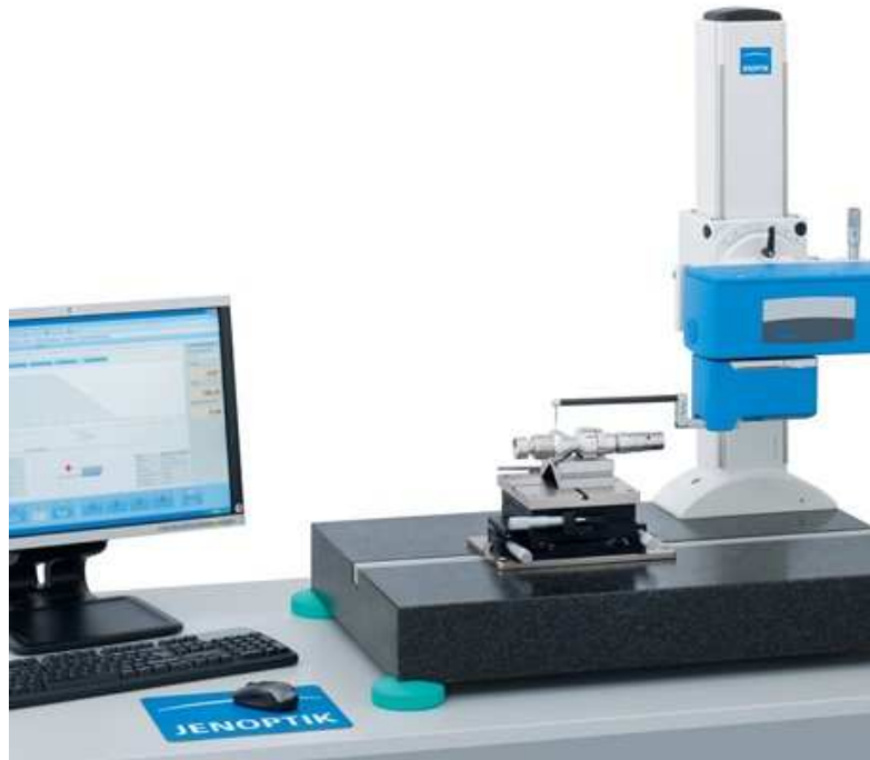
Obrázek P.2 - Drsnoměr Hommel Etamic T8000 [21]
