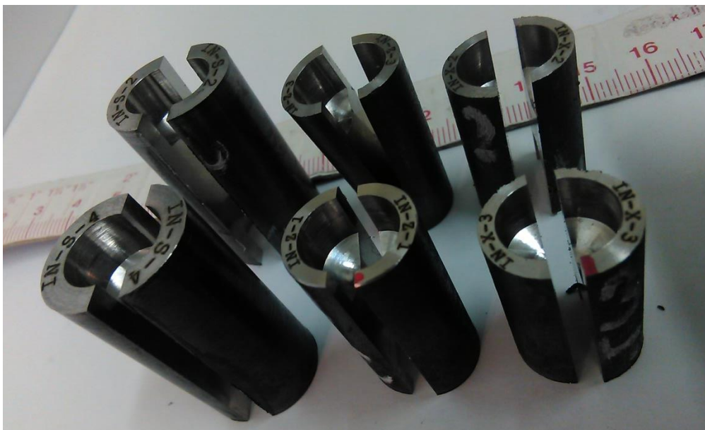
Obrázek 17: Podélně rozříznuté vzorky k analýze vnitřního povrchu otvoru
