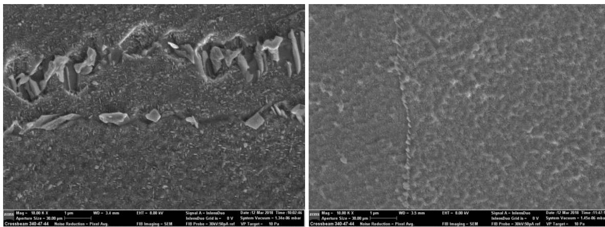
Obrázek 37: Detailní pohled na jehlicovité útvary; vlevo: podélný řez vzorku IN-X-1, zvětšení 10 000x; vpravo: podélný řez vzorku IN-S-1, zvětšení 10 000x
