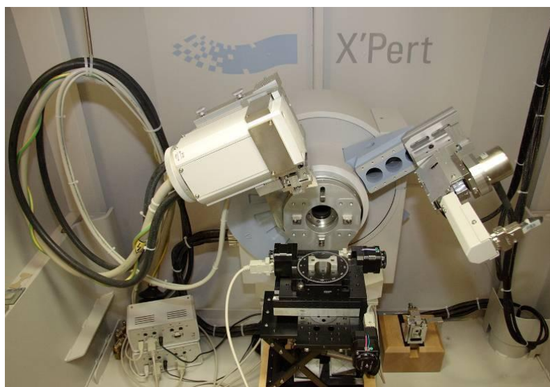
Obrázek 20: \theta - \theta goniometru X'Pert PRO MPD firmy PANalytical v laboratoři rentgenografické tenzometrie KIPL na FJFI v Praze
