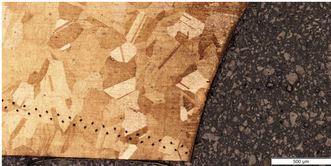
Obrázek 27: Snímek metalografického výbrusu s vtisky po měření mikrotvrdosti HV 0,1
