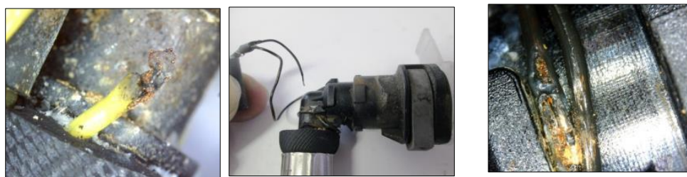
Obr. 32 degradace povlaku na QC během nalisování
