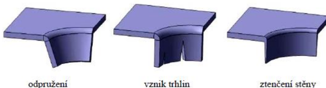
Obr. 12 Defekty lemu [1]
