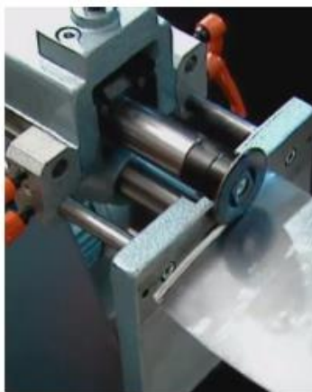
Obr. 21 Lemování pomocí ruční lemovačky [1]
