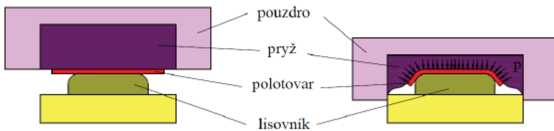
Obr. 14 Lemování nepevným nástrojem [13]
