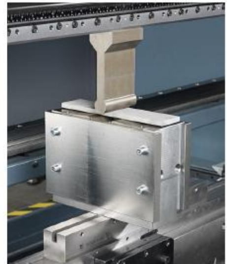
Obr. 10 Nástroj a přípravek pro ohýbání do tvaru U [1]
