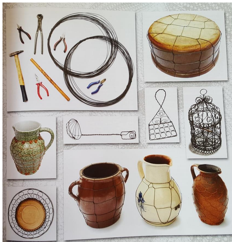
Obrázek 27 Drátování – nástroje opravené nádoby.
