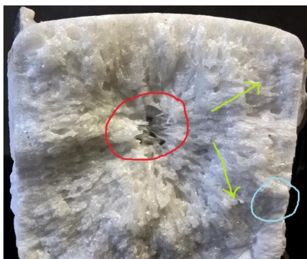
Obrázek 21: Jednorázový odlitek Al_2O_3 ; červená) nejteplejší místo při tavně, zelená) směr růstu krystalů, modrá) skull vrstva
