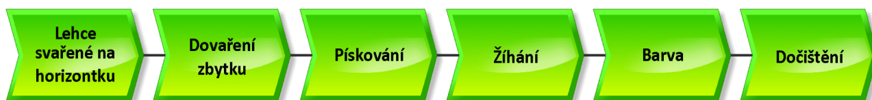
Obrázek 27 Postup práce výroby štítů
