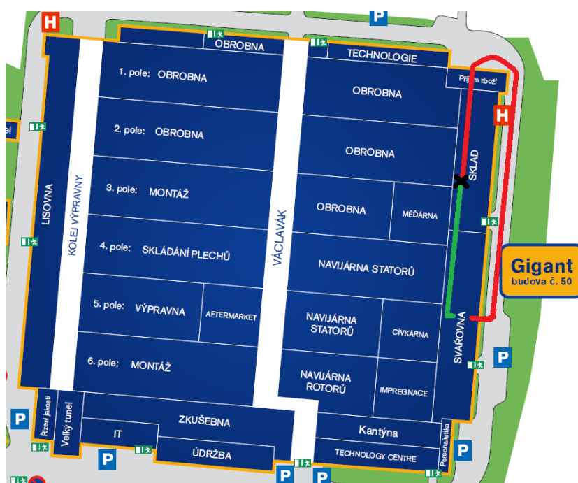
Obrázek 30 Rozdíl vzdálenosti ze skladu do svařovny před a po změně
