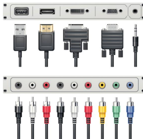
Obr. 2.9 Příklad použití konceptu Poka-Yoke u konektorů. [35]
