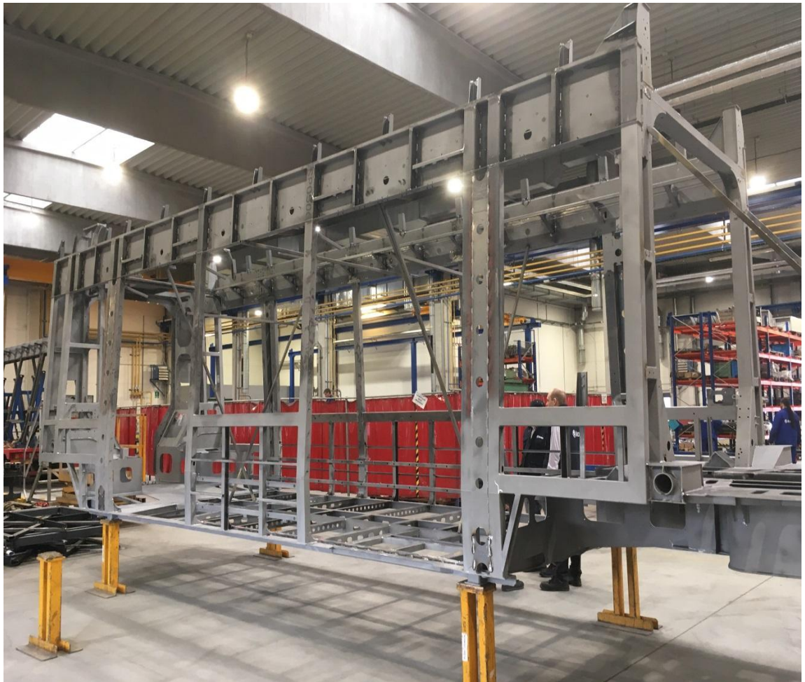
Obr. 7: Ocelová hrubá stavba článku tramvaje
