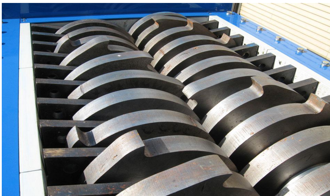
Obr. 28: Dual - Shear M140 – dvouhřídelový drtič (převzato z [52])
