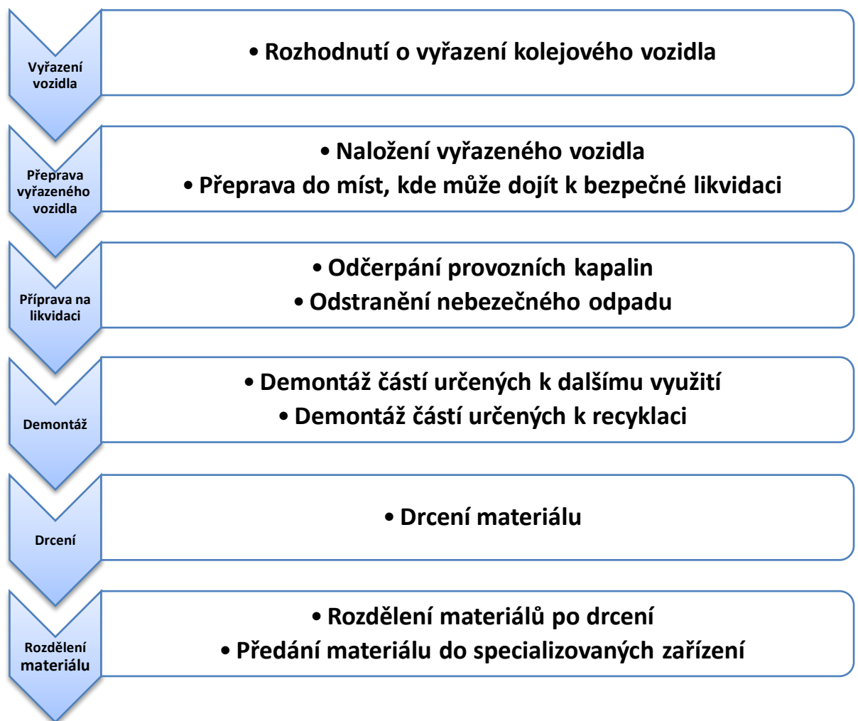
Obr. 23: Jednotlivé kroky likvidace kolejového vozidla
