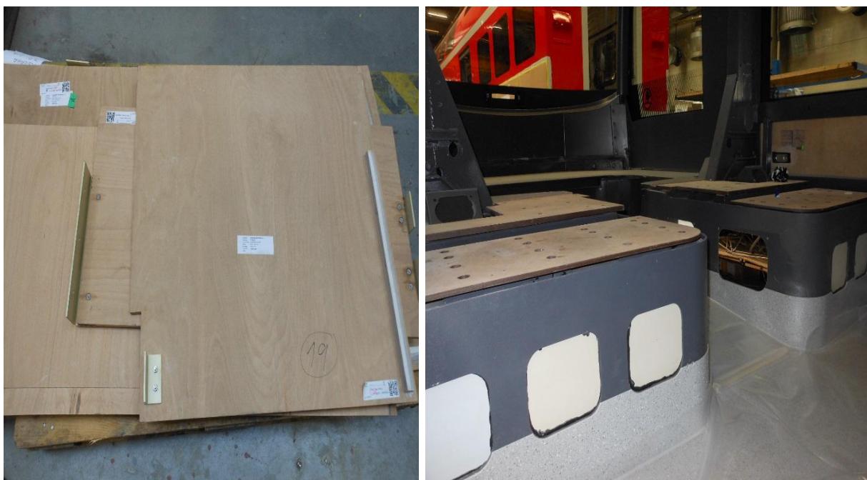
Obr. 10: Překližka připravená k montáži (vlevo) a překližka po namotávání (vpravo)
