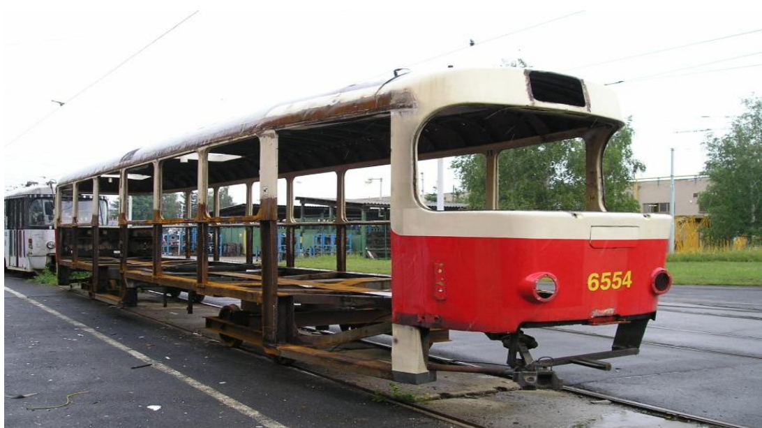
Obr. 26: Finálně odstrojená tramvaj (převzato z [51])
