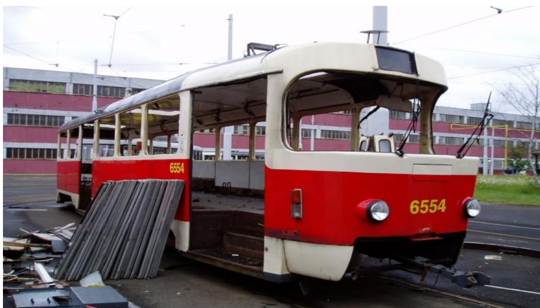
Obr. 25: Průběžně odstrojená tramvaj (převzato z [51])
