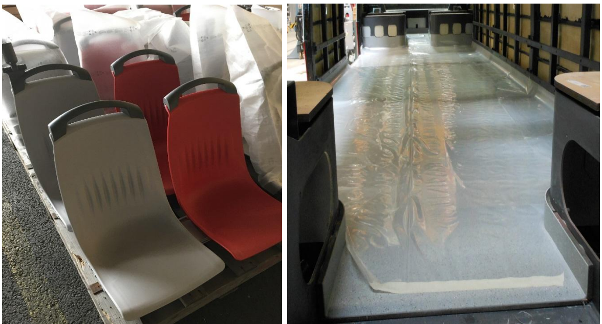
Obr. 9: Příklad využití plastů v kolejovém vozidle – sedačky, lino
