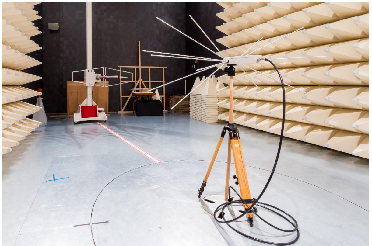
Obr. 28 Horizontální zapojení bikónické a BTA-M antény pro měření útlumu EMC laboratoře
