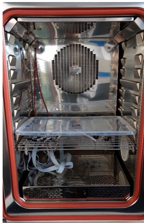
Obrázek 3.7 Plastové víko pro odstínění proudícího vzduchu uvnitř klimatické komory
