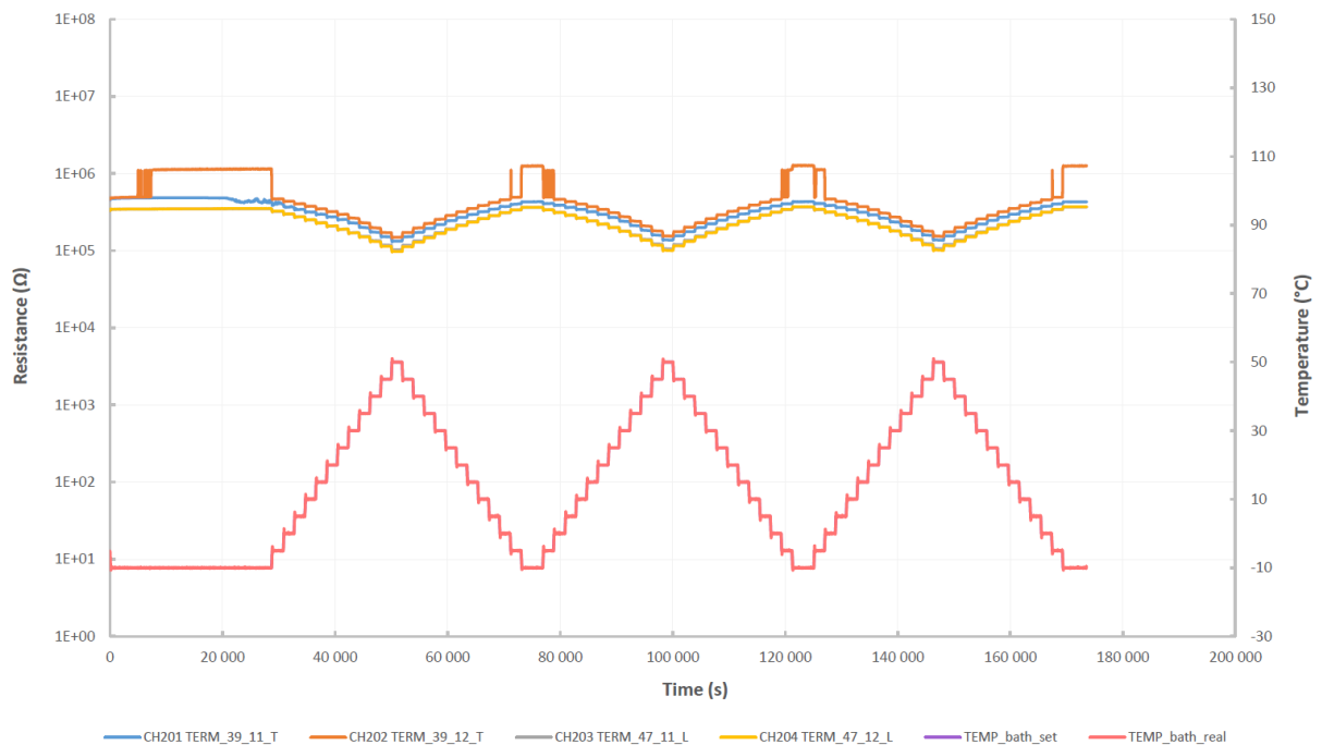
Graf 3.1 Teplotně-odporová závislost vzorků TERM 39 a TERM 47 v olej. lázni
