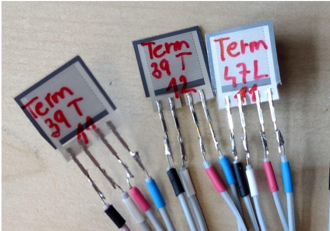
Obrázek 3.2 Nakrimpované piny na vzorcích termistorů s připájenou měřicí kabeláží
