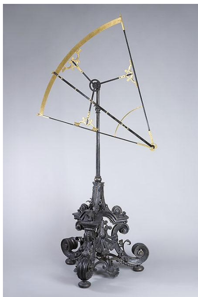
Obr.č. 13 - Trojúhelníkový astronomický sextant pro dva pozorovatele postavené pro Tycha Brahe v roce 1582. Erasmus Habermel (1538-1606), Sextant, 1600, Praha, Národní Technické muzeum, inv. 24551 (zdroj: https://brunelleschi.imss.fi.it/galileopalazzostrozzi/object/ErasmusHabermelSextant.html )
