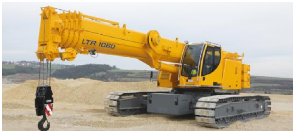
Obrázek – pásový jeřáb LIEBHERR LTR 1060
