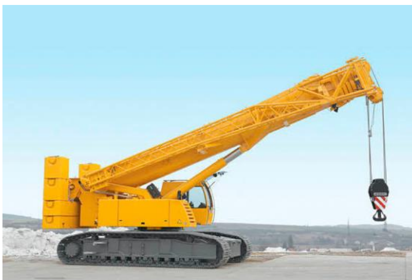
Obrázek – pásový jeřáb LIEBHERR LTR 1100
