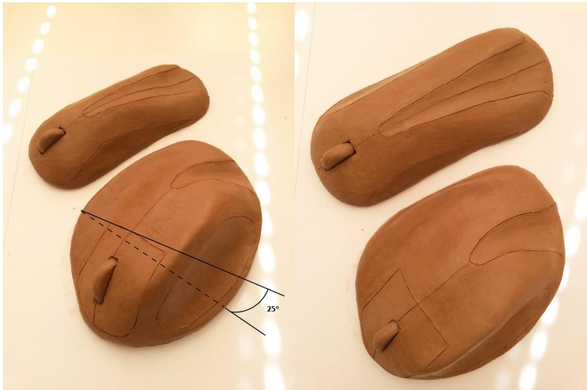
Obrázek č. 31 – Modely počítačové myši z claye s nulovým sklonem (nahore) a sklonem 25°(dole).
