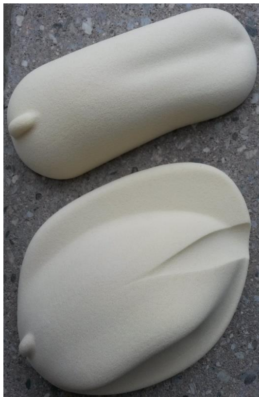
Obrázek č. 37 – Polystyrenové modely myši – 0°(nahore), ergonomická (dole) – shora.
