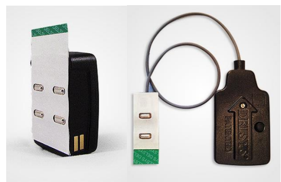
Obrázek č.15b – EMG senzory s oboustrannou lepenkou [25].
