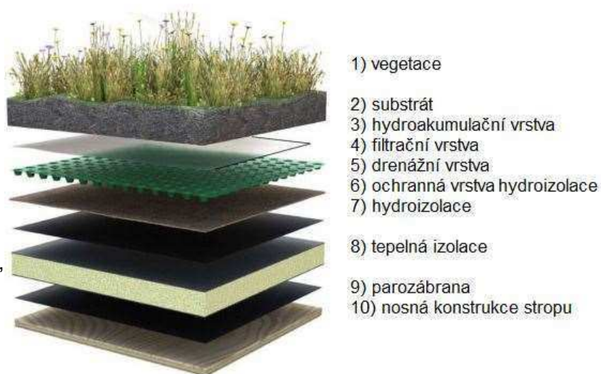
Obrázek 11 Jednotlivé vrstvy zelené střechy
