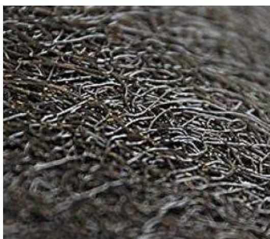
Obrázek 14 Drenážní rohož z prostorově orientovaných PE vláken [ https://www.dek.cz/pobocka-plzen-cernice/produkty/detail/1025160040-dekdren-p-900-sire-1-5-navin-35m ]
