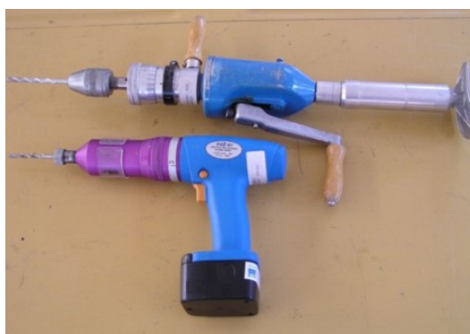
Obr. 2.10. PPZZ 01 elektrická vrtačka a ruční Kučerova vrtačka [18]
