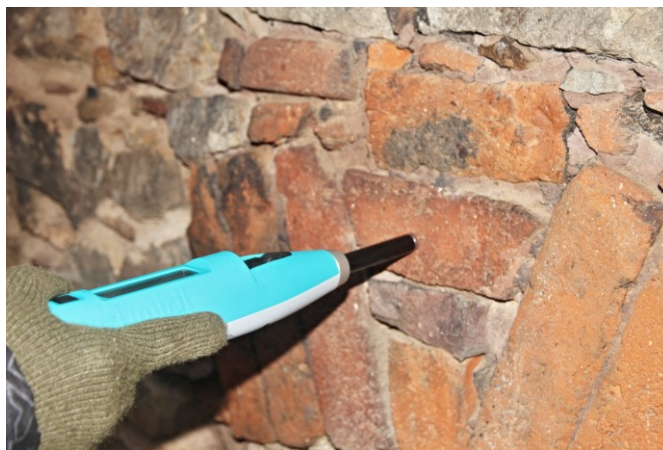
Obr. 6.1. Práce v terénu s Schmidtovým tvrdoměrem typu L
