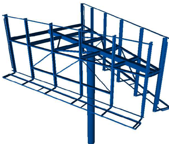
NOSNÝ SYSTÉM S KRUHOVÝM SLOUPEM
