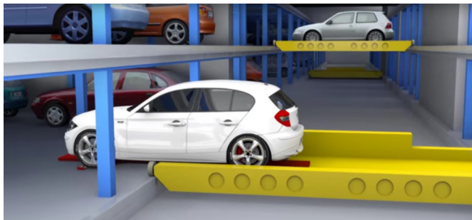
Obr. 23: Horizontální přesuny parkujících vozidel
