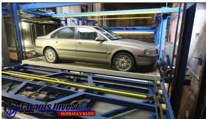
Obr. 17: Prostor paletového APS s podélným uspořádáním (6)
