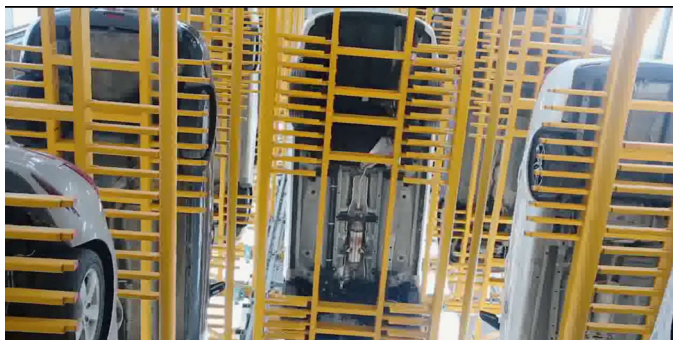
Obr. 20: předání vozidla z vertikální přesuvny na parkovací stání (9)
