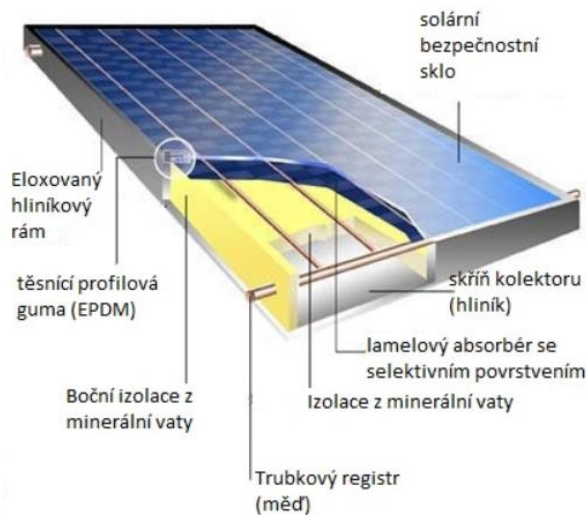
Obrázek 42 Řez solárním kolektorem
