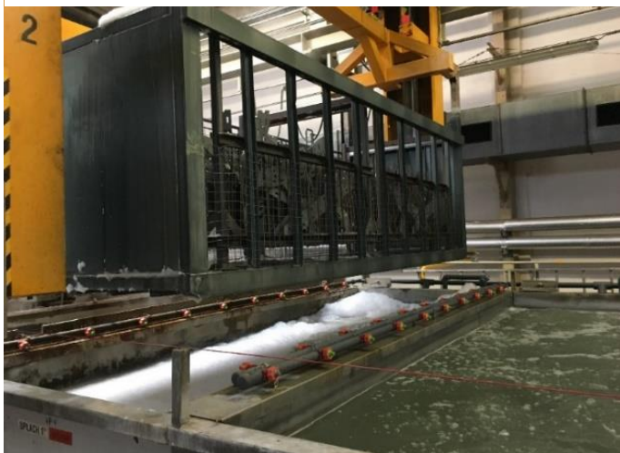
Obrázek 21: Přesun palety v automatizované lince v zařízení PAOB
