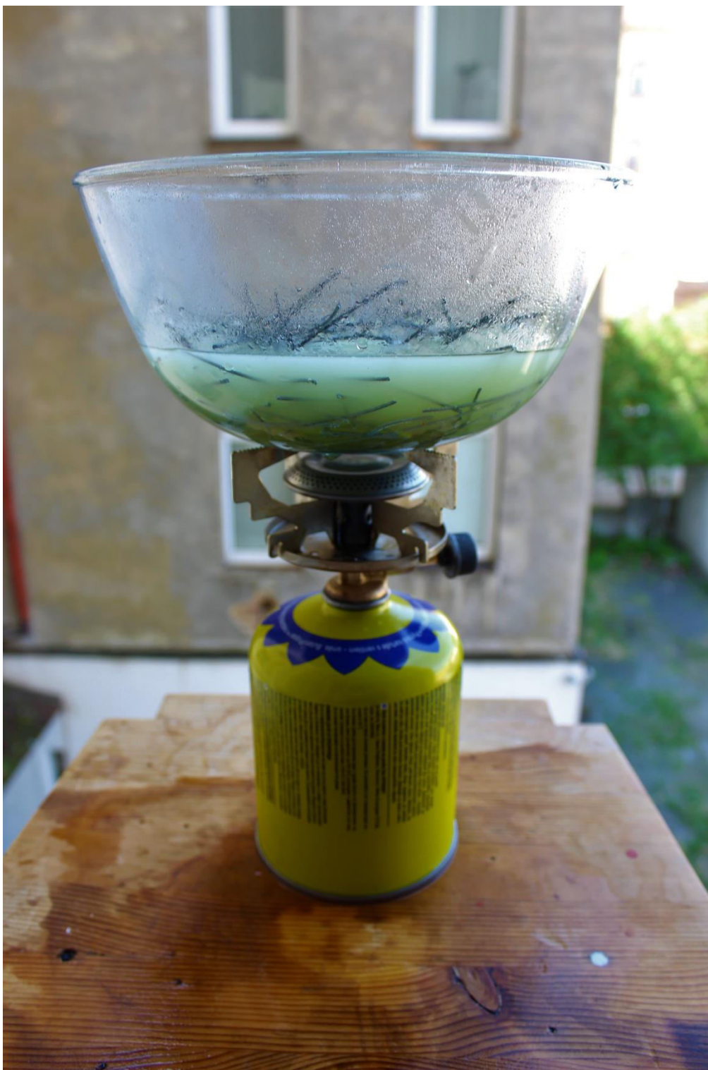
Příprava chloridu zinečnatého v horké lázni kyseliny chlorovodíkové. 23
