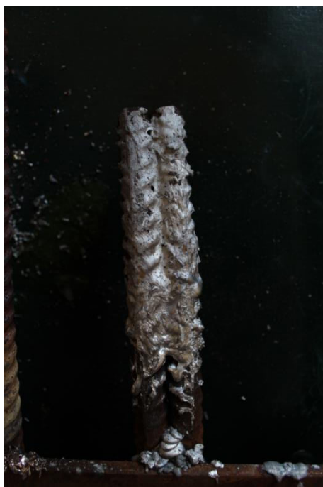
Segment IV – vysoce olovnatý cín (60%Pb / 40%Sn) aplikovaný na očištěném a ošetřeném povrchu chloridem zinečnatým technikou letování. 20
