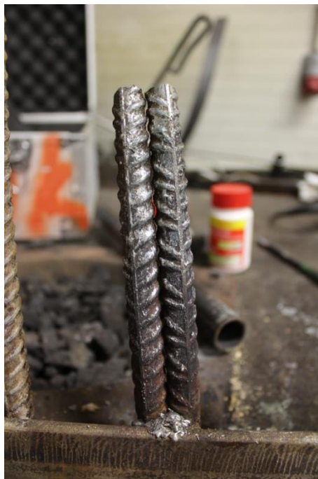
Segment II – cín aplikovaný na očištěném a ošetřeném povrchu modrou skalicí technikou letování. 17
