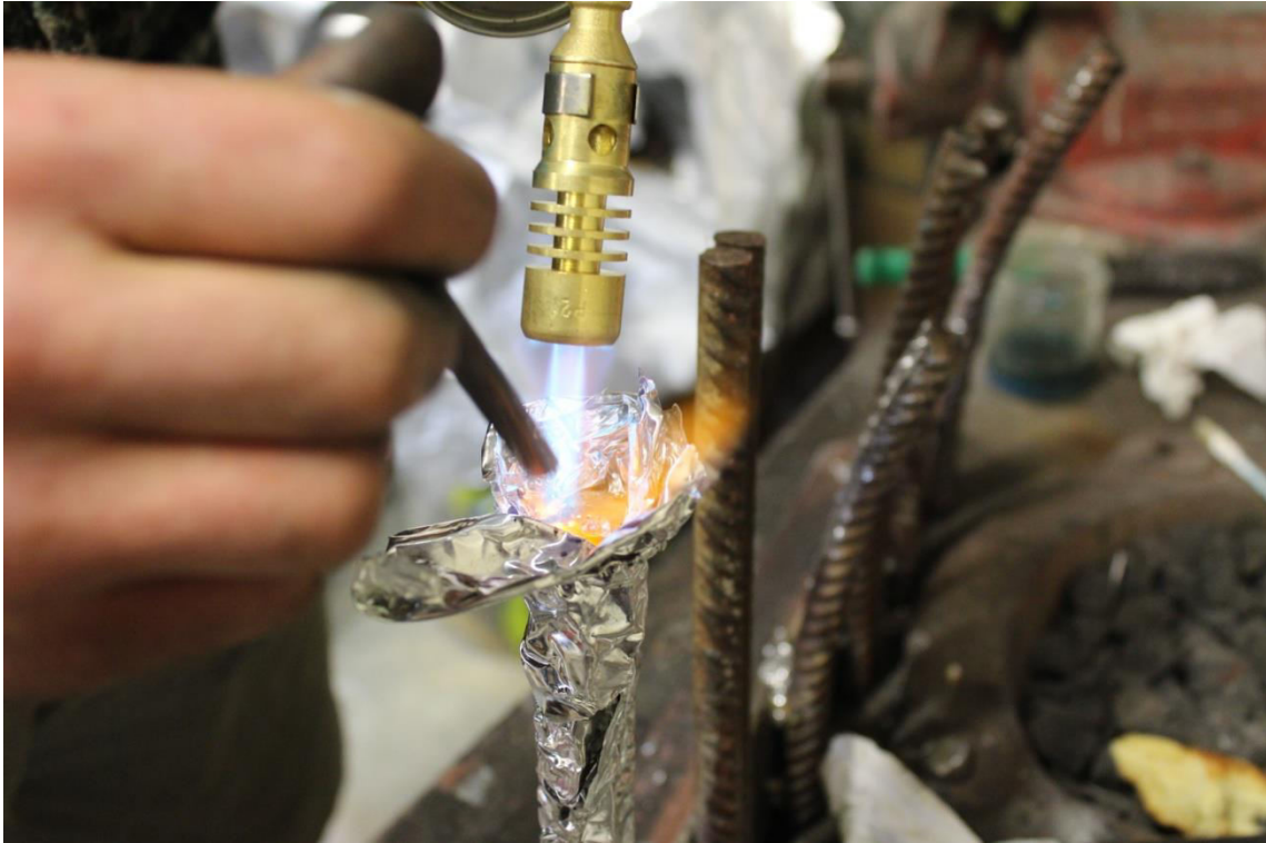
Aplikace odlévání pomocí kapsy ze silnostěnného alobalu 13
