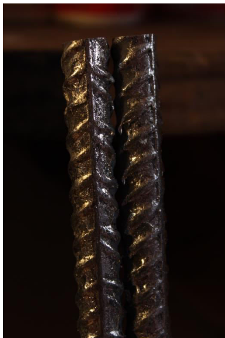
Segment III – cín aplikovaný na očištěném a ošetřeném povrchu chloridem zinečnatým technikou letování. 19
