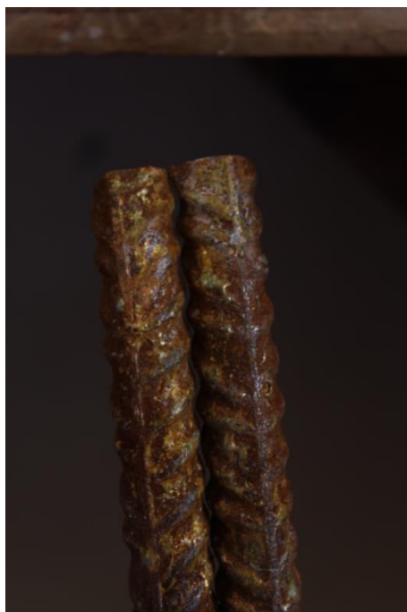
Segment II - cín aplikovaný na očištěném a ošetřeném povrchu modrou skalicí technikou letování, po měsíci působení venkovních vlivů. 18
