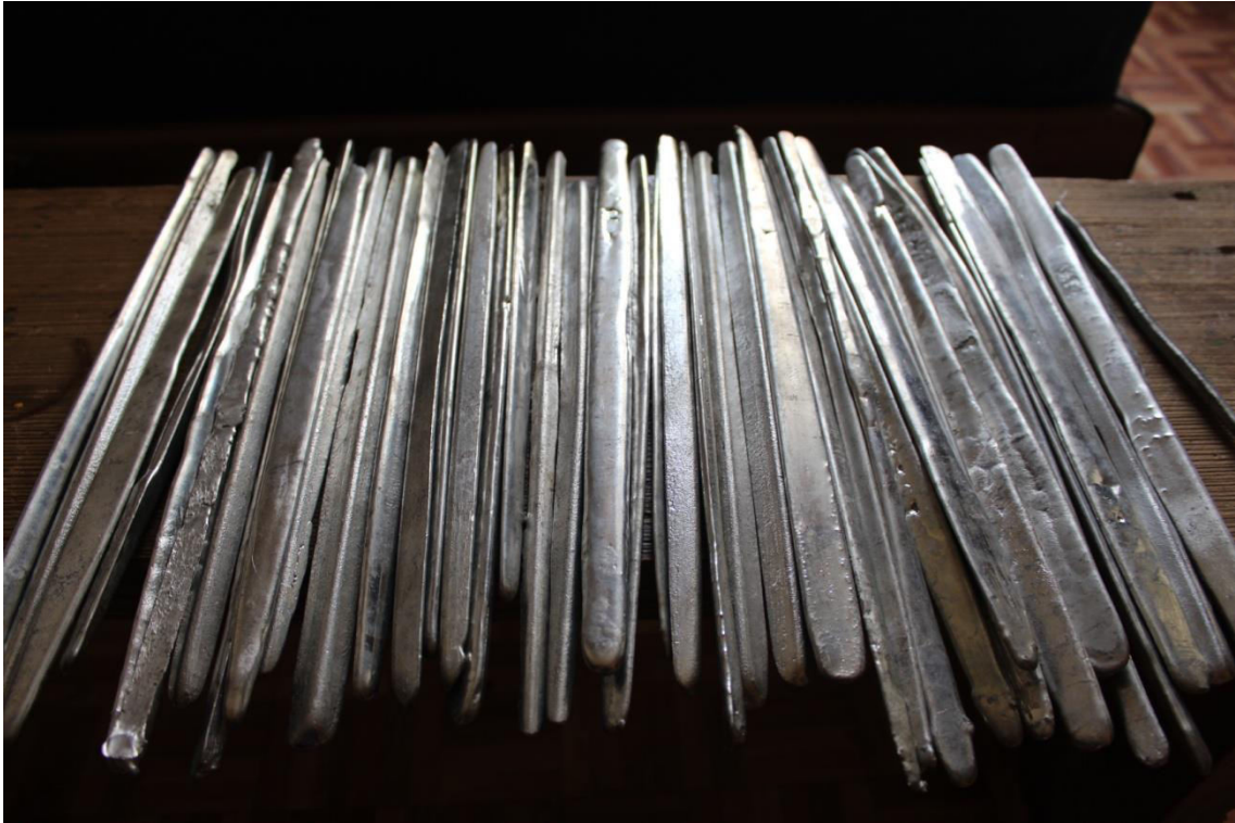
Cínové ingoty (60%Sn / 40%Pb) 15 kg 21
