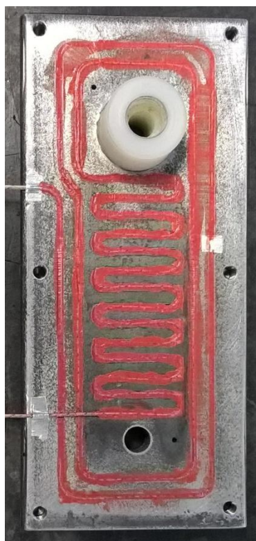
Obr. 4-5 - Montáž topného drátu 10
