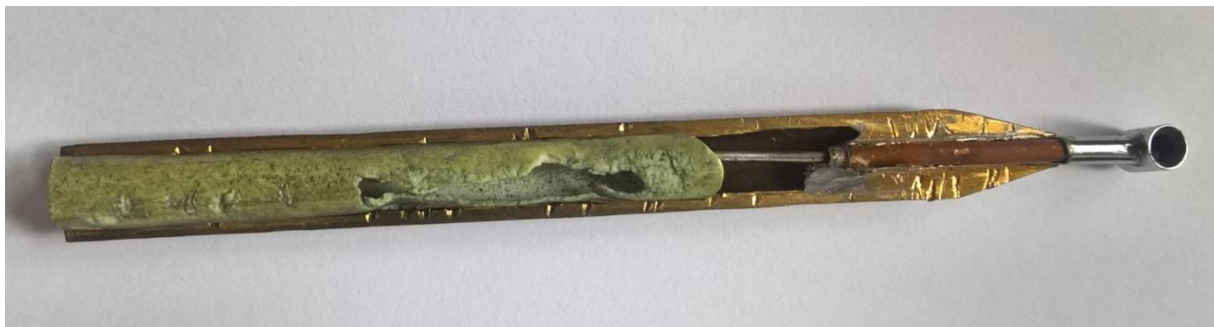
Obr. 2-5 - Řez jednoduchou sondou celkové teploty 5
