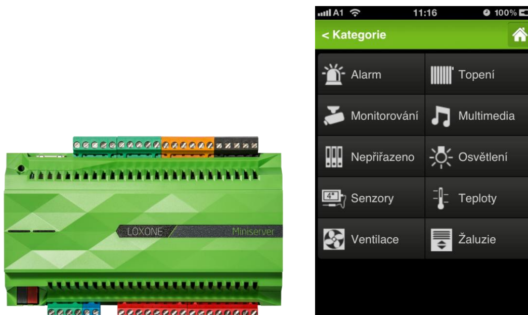
Obr. 4.2 Řídicí jednotka Loxone Miniserver (vlevo), příklad možného ovládání systému Loxone (vpravo) (převzato z [14, 15])
