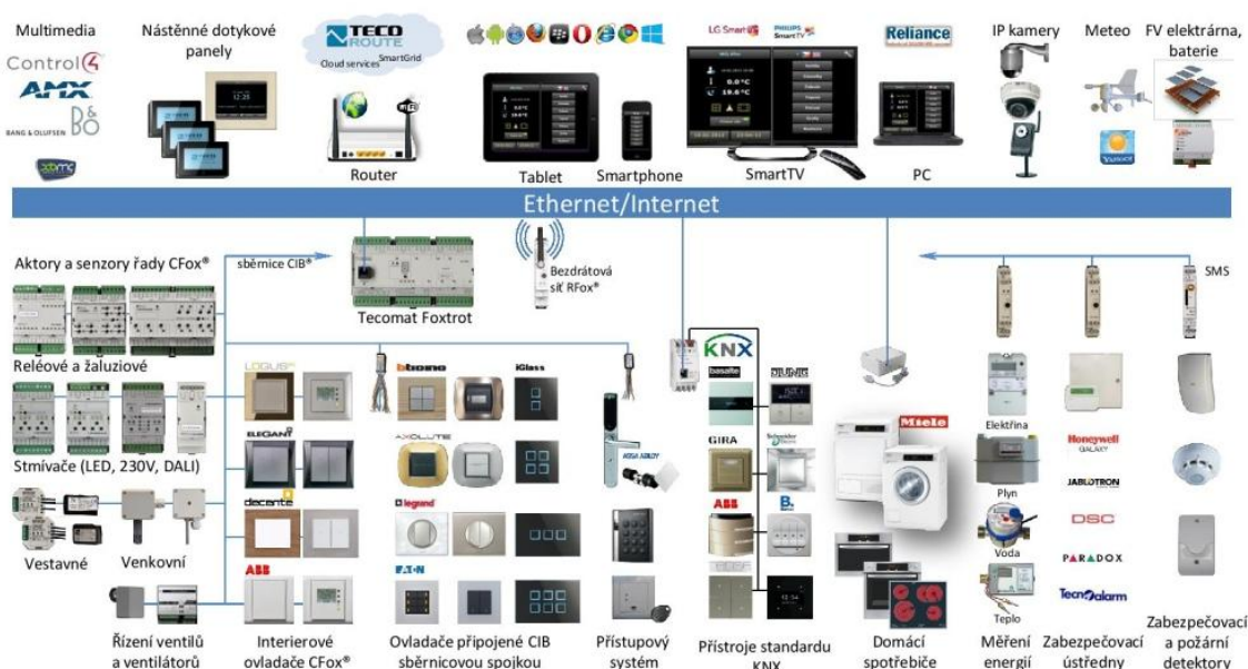
Obr. 4. 4 Struktura systému Tecomat Foxtrot (převzato z [19])
