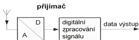
Obr. 1.2.1 Blokové schéma ideálního SDR přijímače. Převzato z: [1].
