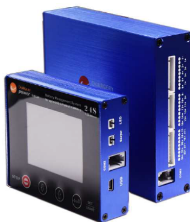
Obr. 2.3: Systém pro správu baterií BMS24T |Převzato z [13]|
