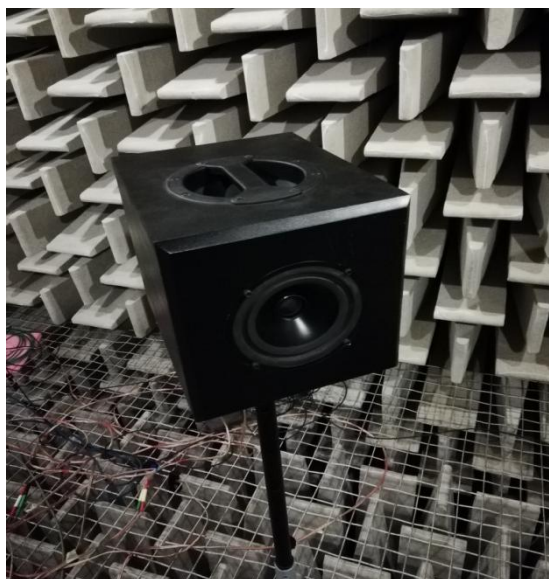
Obrázek 2: koaxiální reproduktor v bezodrazové komoře FEL
