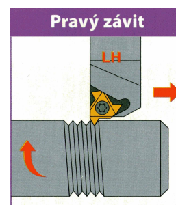
Obr. 84 Metoda soustružení pravého závitu [2].
