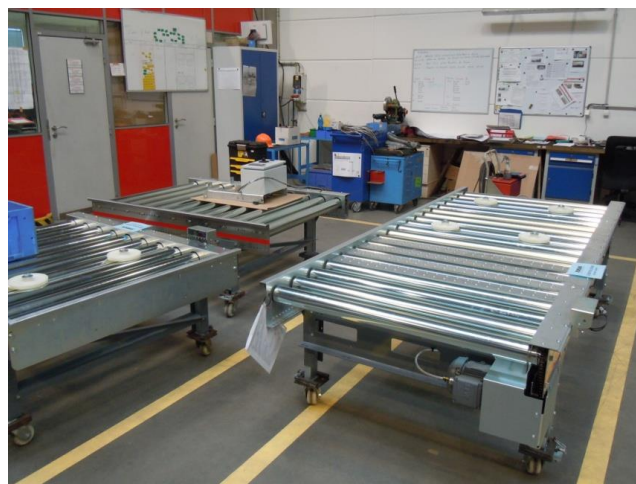
Obrázek 2.11 Zhotovený válcový dopravník, doba montáže až 5h.
