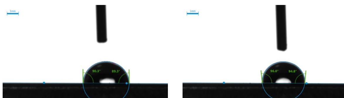
Obrázek 37: Úhel smáčivosti referenčního vzorku 10 sekund po dopadu kapky na povrch (vlevo) a těsně po dopadu kapky na povrch (vpravo)
