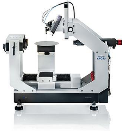
Obrázek: Měřicí přístroj Drop Shape Analyzer – DSA30E [25]
