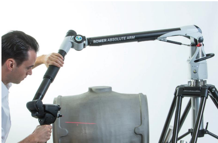
Obr. 4-7 – Ukázka měření ramenem ROMER Absolute Arm s integrovaným skenerem [20]
