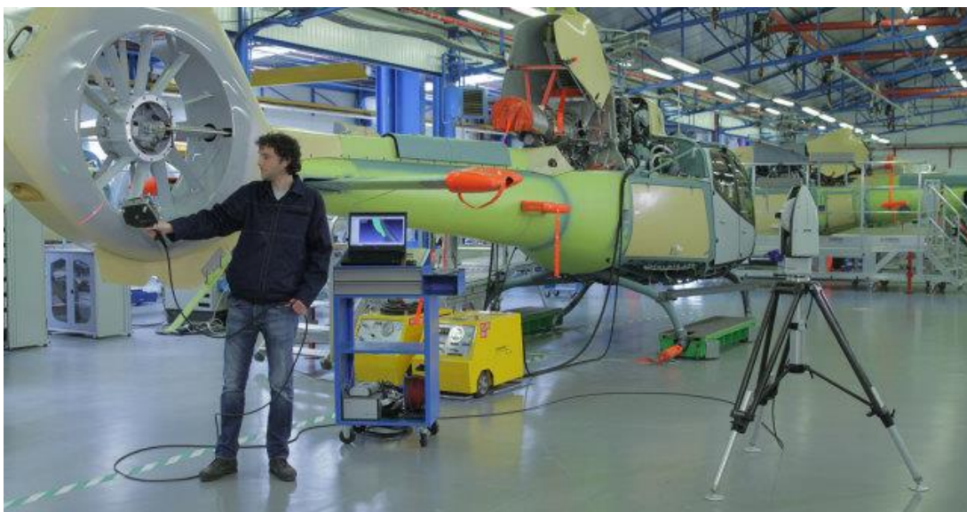
Obr. 4-6 – Ukázka měření pomocí laser trackeru Leica Absolute Tracker [25]
