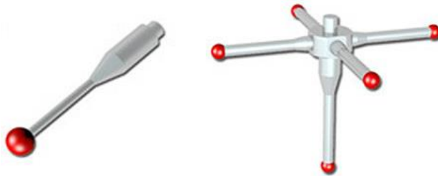
Obr. 2-4 – Zakončení dotykového systému [27]
