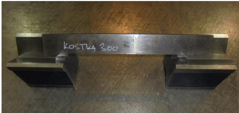
Obr. 3-2 – Měřená koncová měrka [vlastní]
