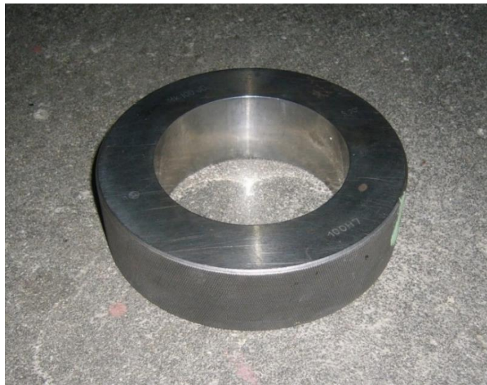
Obr. 3-12 – Měřený kalibrační kroužek – vnitřní průměr [vlastní]
