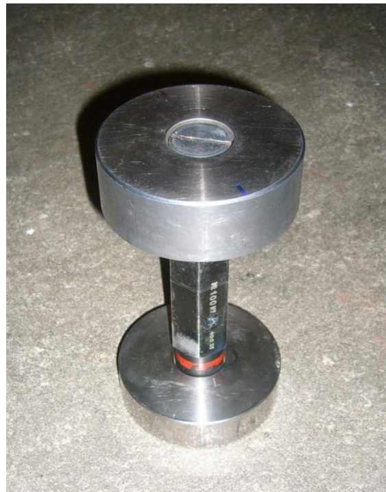
Obr. 3-11 – Měřený válcový kalibr – vnější průměr [vlastní]
