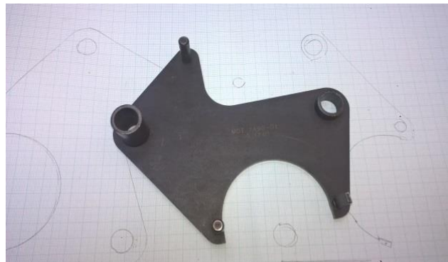
Obr. 4 – Stávající Aretační deska
