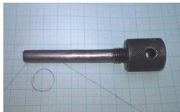
Obr. 5 – Stávající Aretační šroub (TDC)
