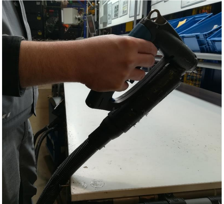
Obrázek 5-8: Správný úchop a umístění lepicí pistole
