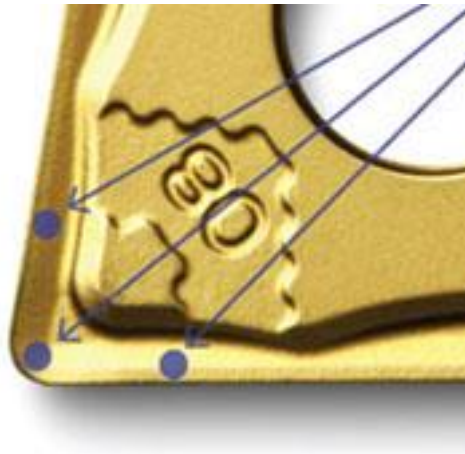
Obr. 4-4 – Speciální geometrie VBD pro HPC obrábění [8]
