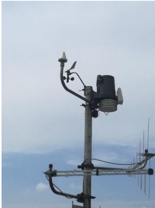
Obr. 6.6: Střešní GPS anténa.
