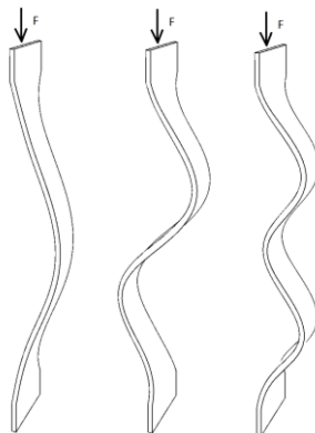
Obrázek 28 - Vzpěrová deformace standartní zkušební tyče v MKP
