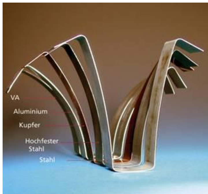
Obrázek 15 - Odpružení u plechů různých materiálů [13]
