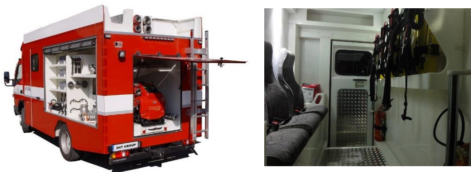
Obr. 4-18 Nástavba ZHT a pohled do prostoru posádky [30]
