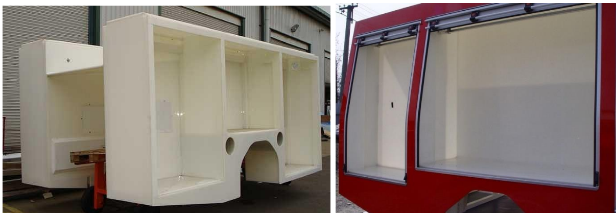
Obr. 4-15 Hrubá nástavba pro CAS MAN, vpravo nástavba s roletami [35]
