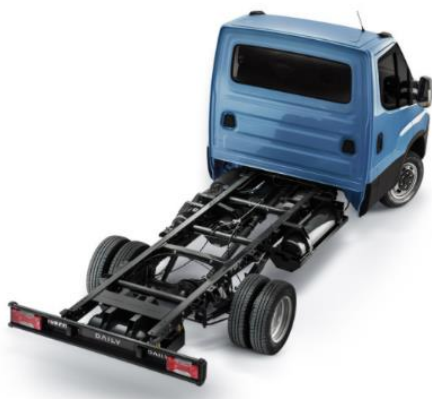
Obr. 4-11 Podvozek Iveco Daily E6, vpravo nástavbou od firmy THT [28][32]
