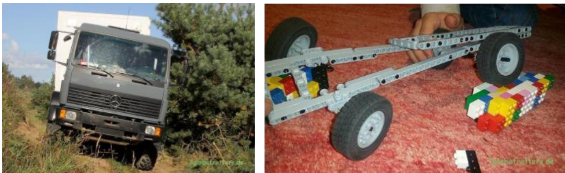
Obr. 4-4 Zkroucení podvozku MB 1124 AF s pružným spojením, vpravo model ze stavebnice [18][19]]
