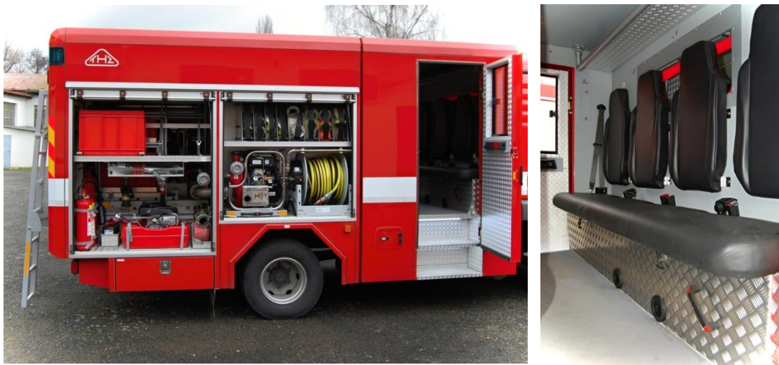
Obr. 4-19 Nástavba DA na podvozku MAN TGL 12, napravo prostor pro posádku [33]
