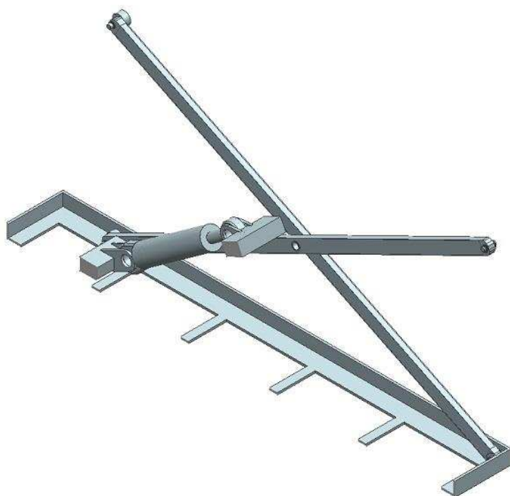
Obrázek 74 3D pohled v řezu na zvedák
