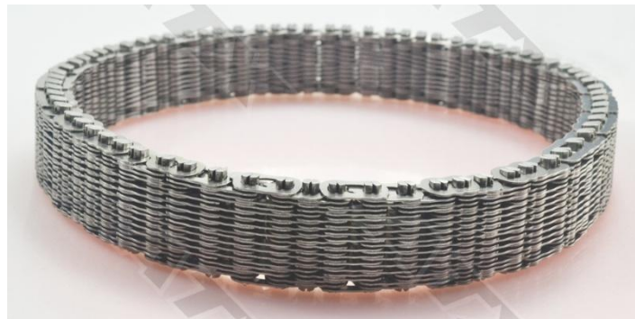
Obrázek 8: Řetěz pro CVT převodovky od VW, viz [95].
