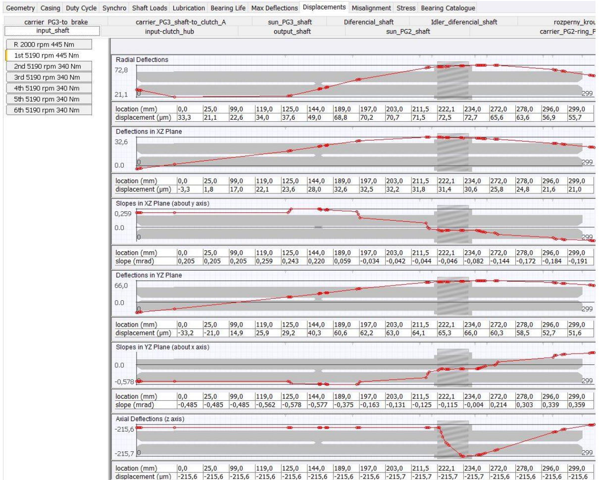
Obrázek 9: Kontrola deformací a naklonení dílů převodovky.
