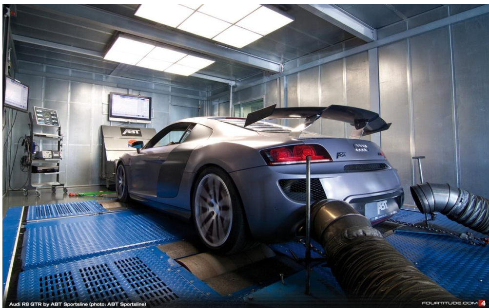
Obr. 4: Měření jízdních charakteristik vozu na brzdové válcové stolici (dynamometru), viz [8].
