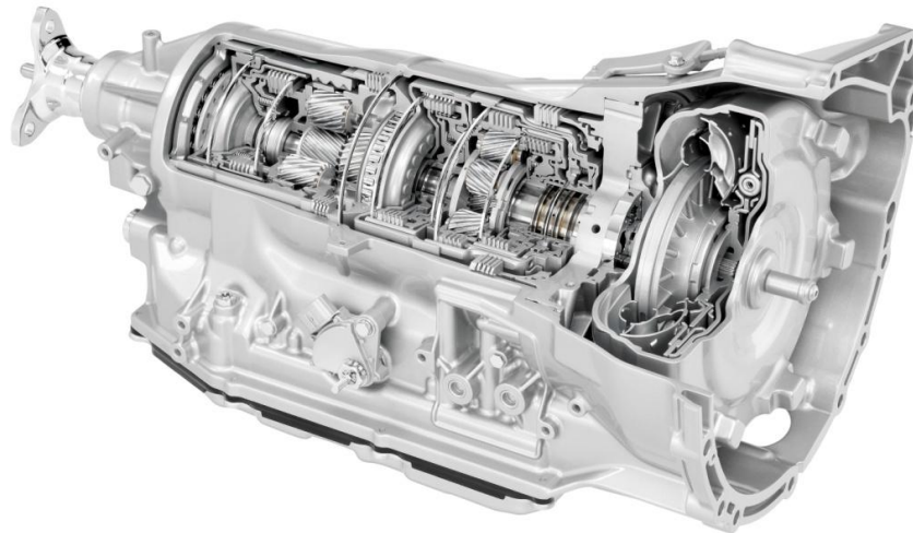
Obr. 6: Ukázka automatické osmistupňové převodovky Aisin TL-80SN ve čtvrtinovém řezu skříní převodovky a hydrodynamickým měničem momentu, viz [13].
