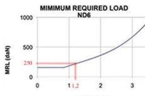
Graf 8.1 - Minimální zatížení Spiralliftu v závislosti na zdvihu [20]
