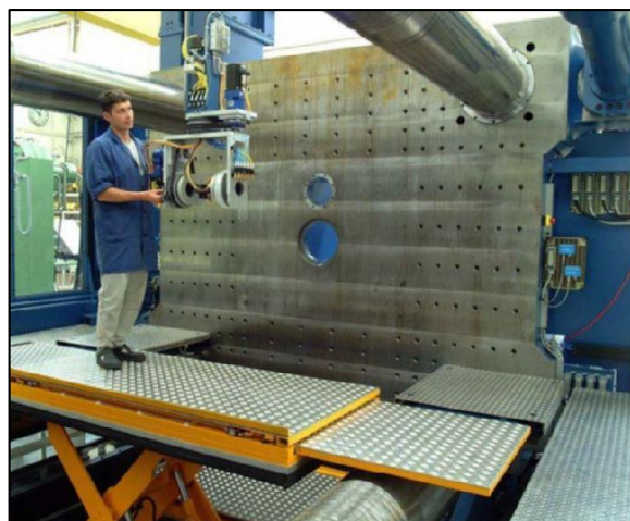
Obr. 1.3 - Umístění zdvihací plošiny uvnitř stroje [22]
