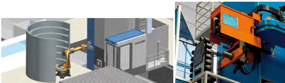
Obr. 6. RTC robotická výměna nástrojů (vlevo), ATC automatická výměna nástrojů (vpravo) [5]
