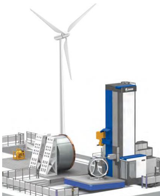
Obr. 7. Naklápěcí stůl při obrábění vrchlíku větrné elektrárny (Škoda tdv tilt) [5]
