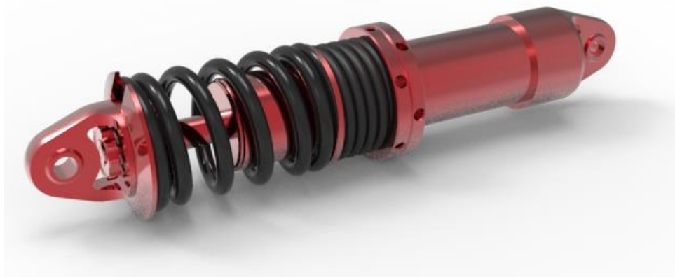
Obrázek 3-5 – Render modelu tlumiče s tlačnými pružinami
