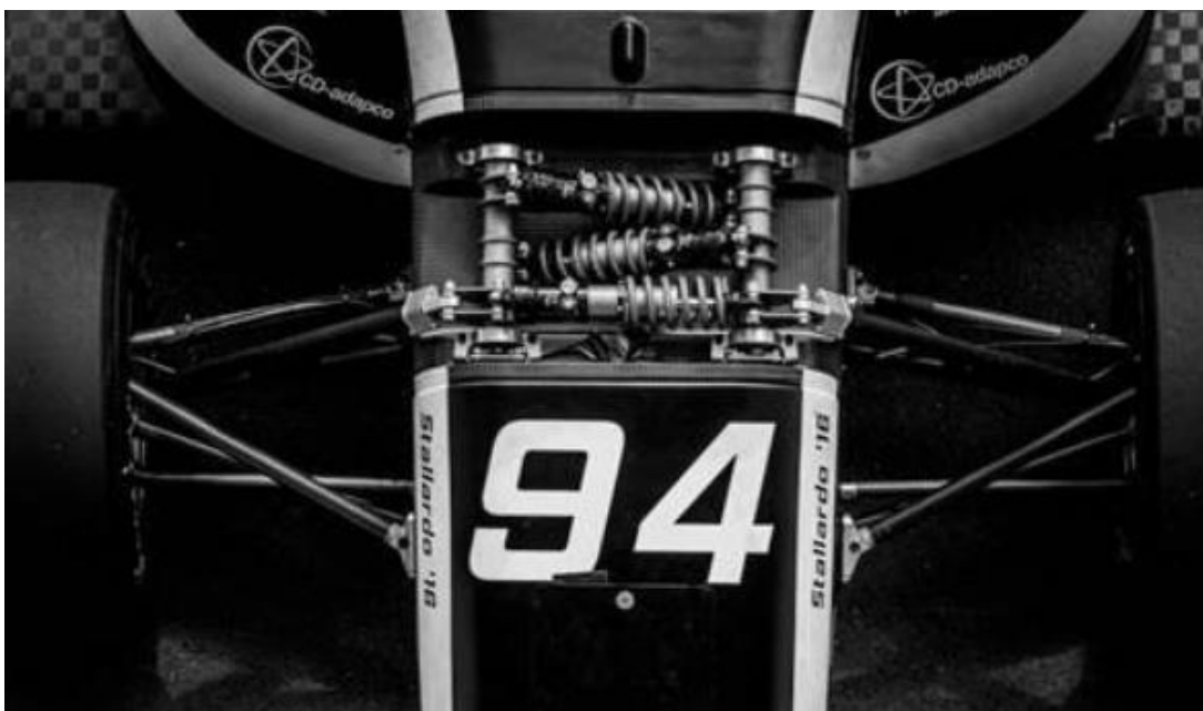
Obrázek 2-5 – Přední zavěšení nápravy týmu Rennstall Esslingen se třemi tlumiči [3]
