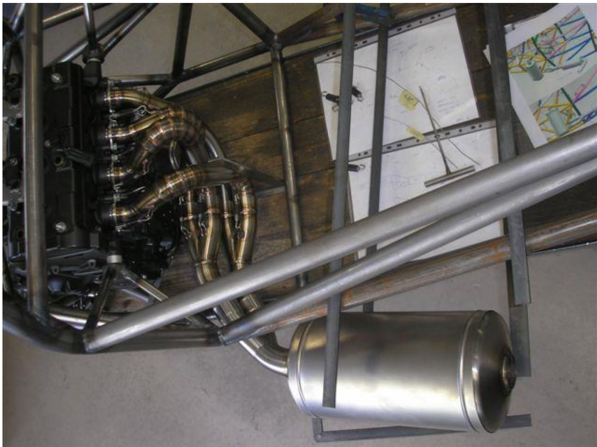
Obr. 77 Výroba výfukového systému pro vůz UWB04
