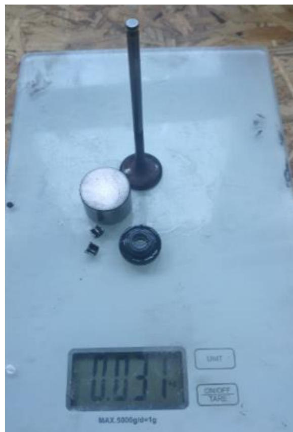
Obr. 84 Hmotnost ventilových komponent bez pružiny z motoru Yamaha YZF-R6
