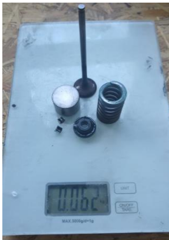
Obr. 83 Hmotnost ventilových komponent z motoru Yamaha YZF-R6
