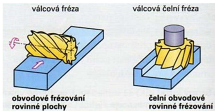
Obrázek 9 - Čelní a obvodové frézování [4]
