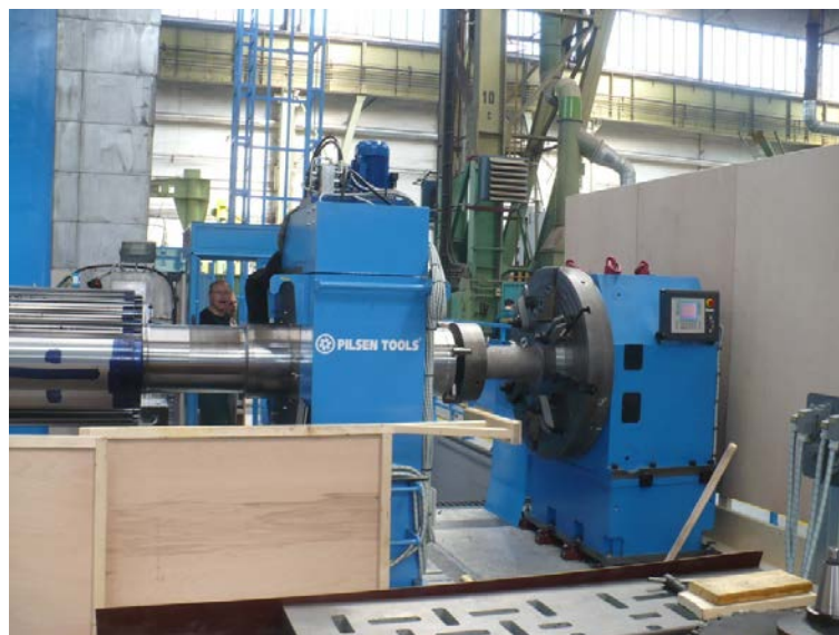
Obrázek 36 - Vodorovné polohovadlo ŠMT z typové řady IOV [1]
