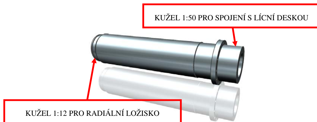
Obrázek 72 - Vřeteno natáčecího vřeteníku
