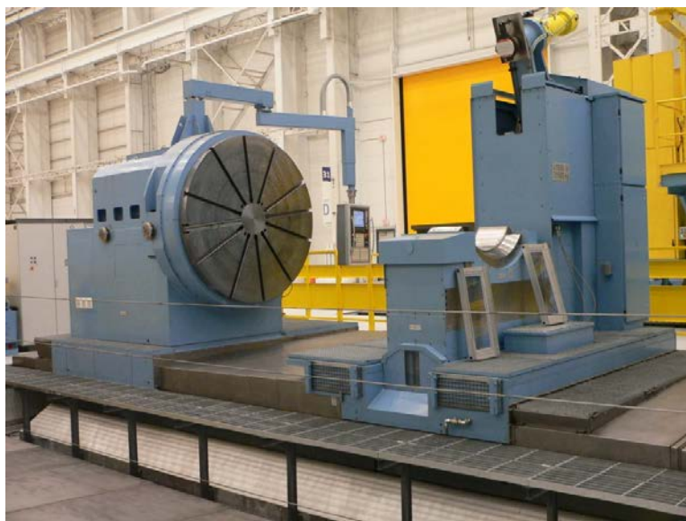
Obrázek 36 - Vodorovné polohovadlo ŠMT z typové řady IOV [1]
