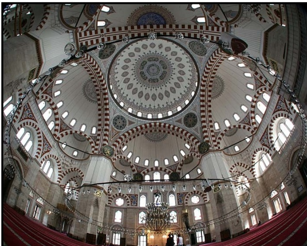
Obr. 17 Kopule princovy mešity. Hlavní kopule je podepřena čtyřmi polokopulemi
