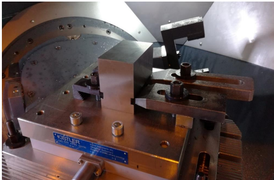
Obrázek 4-10 - Upevnění dynamometru a polotovaru [3]
