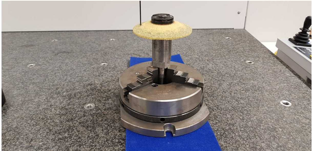
Obrázek 90 Měření tvaru brusného kotouče po broušení
