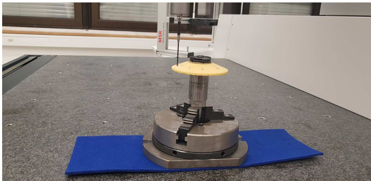
Obrázek 79 Měření brusného kotouče po orovnění
