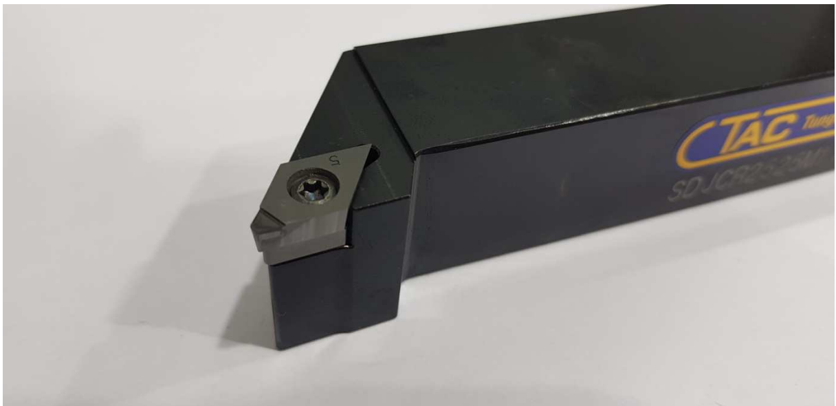
Obrázek 75 Sestava upnutí destičky v držáku
