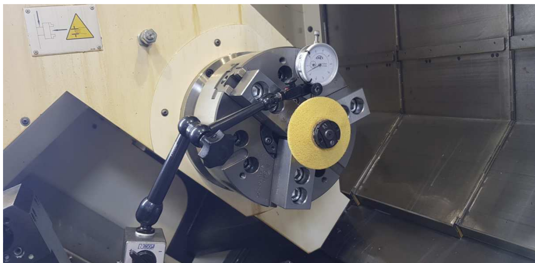
Obrázek 77 Měření házení upnuté sestavy brusného kotouče
