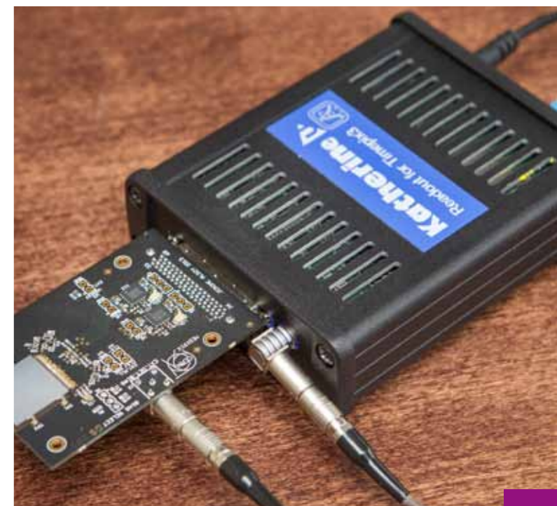
Systém „Katherine“ se senzorem Timepix3 umožňuje zachytit částice ionizujícího záření a poskytnout informace o intenzitě, odevzdané energii a časových parametrech interakce.
