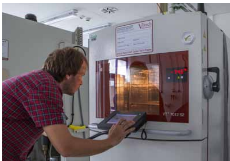
Klimatická komora testuje odolnost materiálů teplotními šoky.
