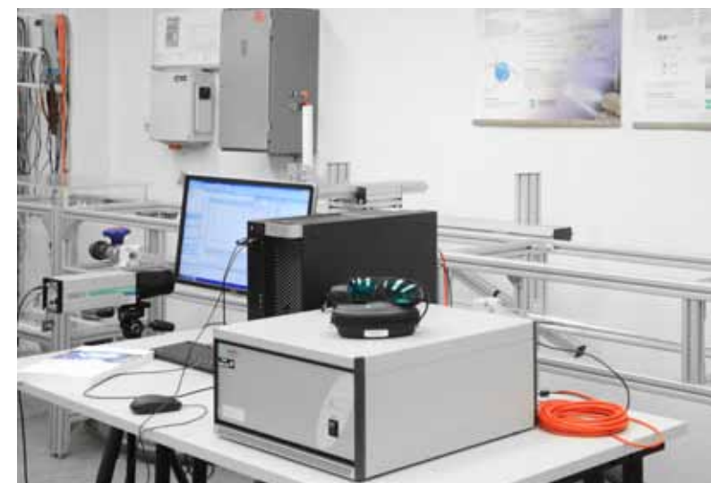
Měřicí aparatura LDA (Laser Doppler Anemometry) pro měření rychlosti proudění.
