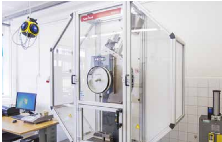
Instrumentované Charpyho kladivo s maximální kapacitou 450 J určené na provádění zkoušek rázem v ohybu, a to v teplotním rozmezí od teplot -196\text{ }^{\circ}\text{C} až do 1200\text{ }^{\circ}\text{C} .
