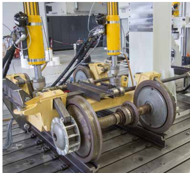
Testování komponent nového podvozku pro úzkorozchodné tramvajové vozidlo. Ověřuje se rám podvozku a primární vypružení, na které se použily nestandardní listové pružiny.
